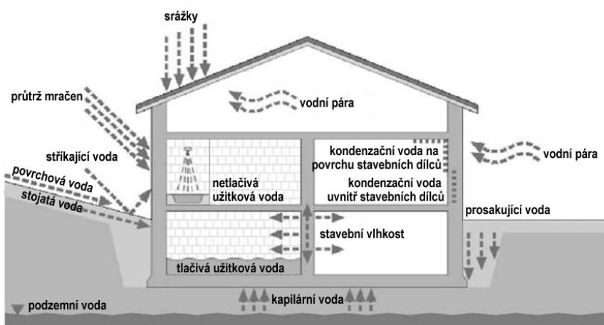
Obr. 1: Typická zatížení budovy vlhkostí (Fischer et al. , 2008)
